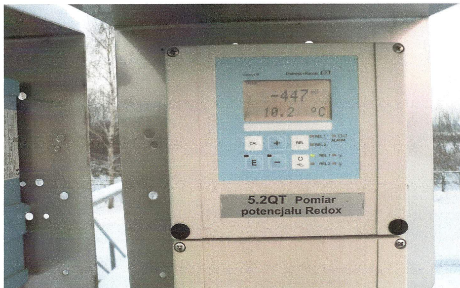
Rys. 5. Fotografia wskazań sondy Redox w komorze niedotlenionej 1
